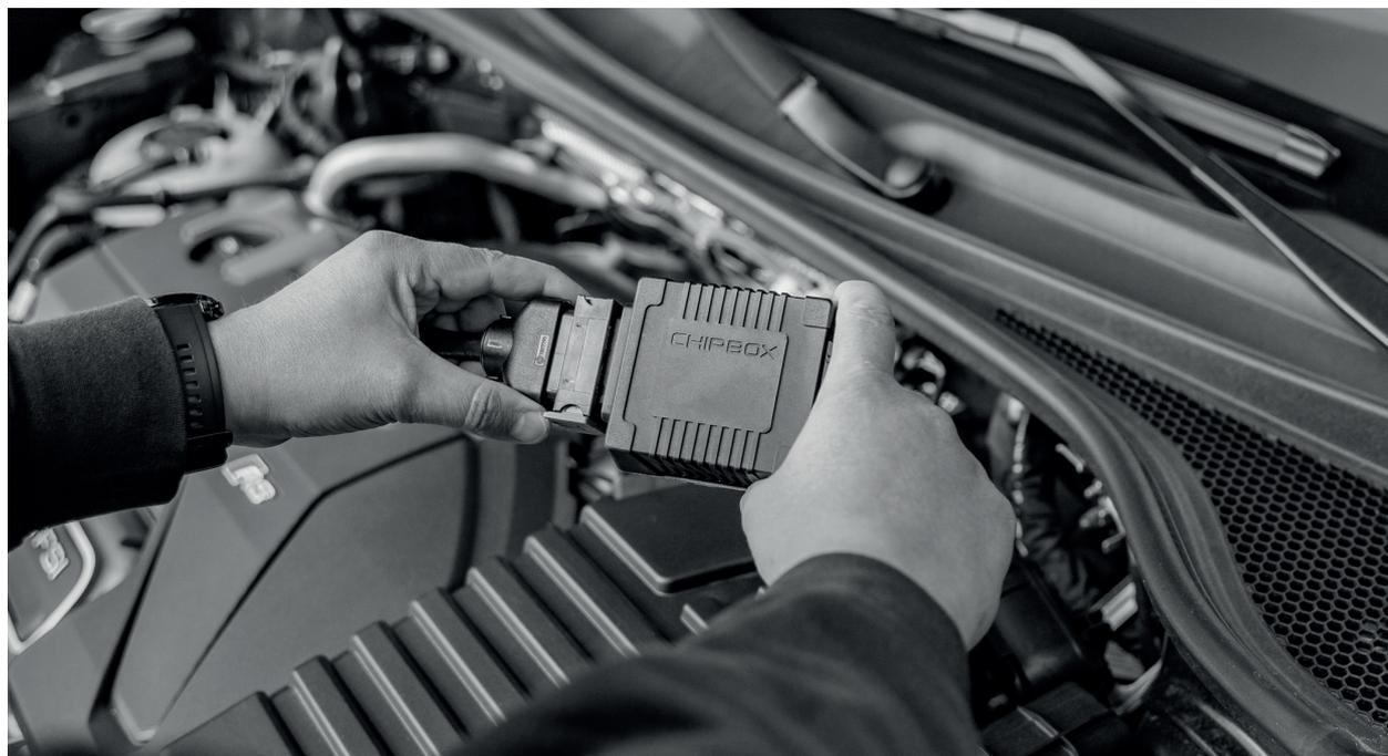
**Rimuovi il connettore di BYPASS dal cablaggio e collega la centralina CHIPBOX.**
